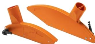
**Schutzhaube transparent FSSH 3** mit Anschluss für Absaug Schlauch 60 mm und Pendelschutz, für max. **Sägeblattdurchmesser 315 mm** zur Montage am Spaltkeil – **Best Nr. 40515**
